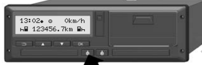
Şekil 8: Kart isteme (kombine tuş)
