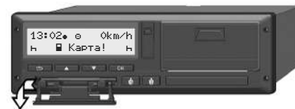
Рис. 9: Откидывание крышки вниз
