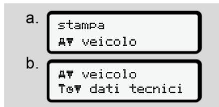
Fig. 91: Sequenza del menu stampa - dati tecnici
