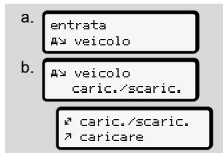
Fig. 108: Sequenza menu Carico/Scarico
