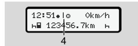
Fig. 14: Pittogramma: Scarico tramite controllo remoto
