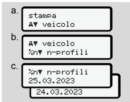
Fig. 96: Sequenza del menu stampa - profili dei giri del motore
