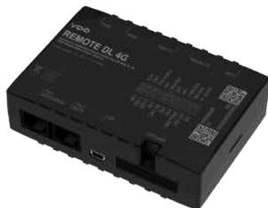
Con il Remote DL 4G di VDO possono essere trasferiti dati di download mediante GPRS al sistema di gestione della flotta o a un software di valutazione.
