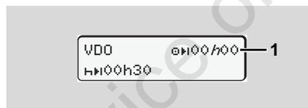
Après confirmation de la 2<sup>ème</sup> "Alerte de temps de conduite" le VDO Counter indique que votre temps de conduite **(1)** est terminé. (Sauf en fonctionnement Hors champ.)
