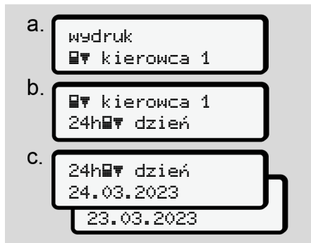
Rys. 84: Sekwencja menu do wydruku danych dziennych kierowcy 1
