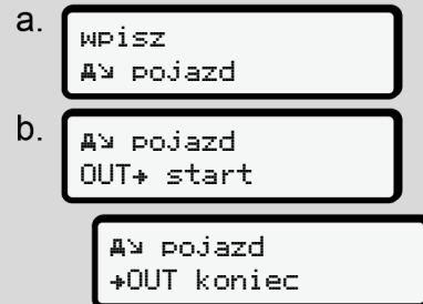
Rys. 106: Sekwencja menu do wpisu Out start / koniec
