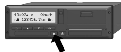
Rys. 8: Żądanie karty (przycisk kombinowany)
