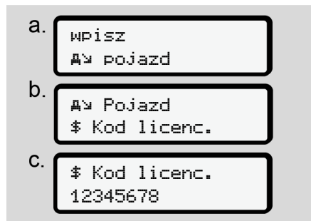
Rys. 116: Sekwencja menu wpisu kodu licencyjnego
