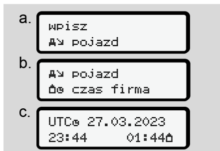
Rys. 111: Sekwencja menu wpisu czasu lokalnego
