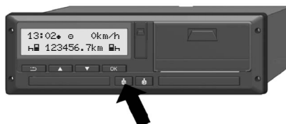
Rys. 11: Żądanie karty (przycisk kombinowany)
