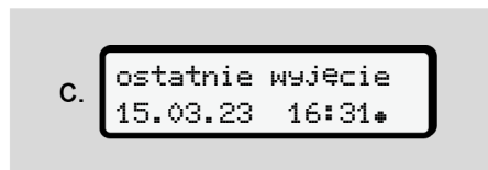
Rys. 17: Wskazanie czasu ostatniego wyjęcia karty
