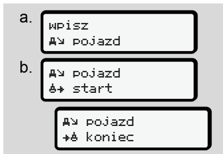
Rys. 107: Sekwencja menu do wpisu transportu promem / koleją
