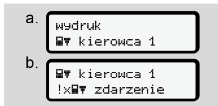
Rys. 85: Sekwencja menu do wydruku zdarzeń
