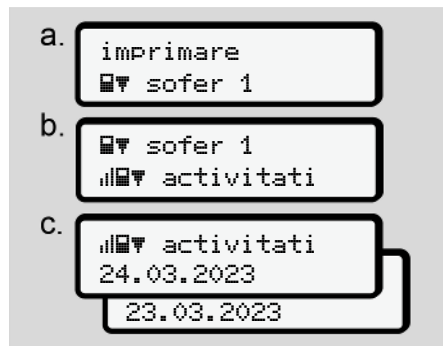
Fig. 86: Secvență de meniu Imprimare – activități
