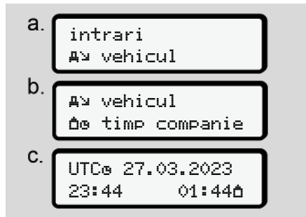
Fig. 111: Secvență de meniu Introducere – Oră locală
