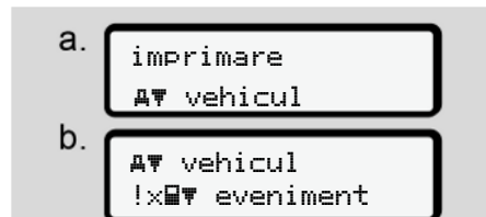
Fig. 89: Secvență de meniu Imprimare – Evenimente vehicul
