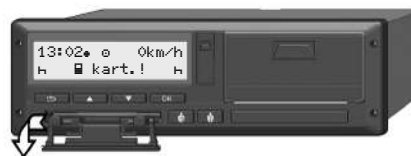
Slika 9: Preklapanje poklopca prema dolje
