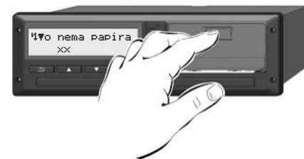
Slika 141: Pritiskanje tipke za deblokiranje
