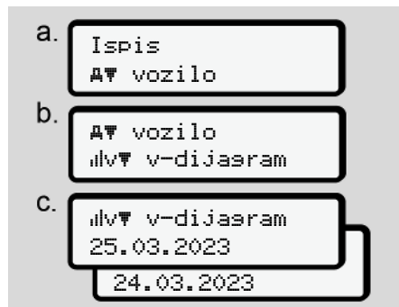
Slika 93: Slijed izbornika za ispis – dijagram brzine
