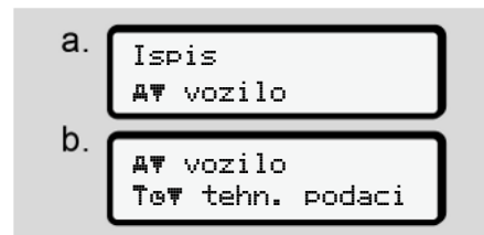
Slika 91: Slijed izbornika za ispis – tehnički podaci
