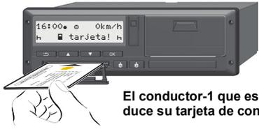
El conductor-1 que estará efectivamente al volante introduce su tarjeta de conductor en el lector de tarjetas-1.
