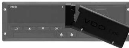
O VDO Link é um módulo complementar para aceder remotamente e em tempo real aos dados do veículo e do tacógrafo (por exemplo, para a função telemática e o serviço de portagens).
