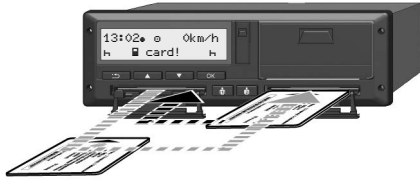
Fig. 36: Schimbare cartelă de conducător auto
