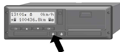
Fig. 53: Solicitarea cartelei de întreprindere (tastă combinată)
