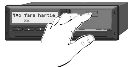
Fig. 141: Apăsați tasta de deblocare
