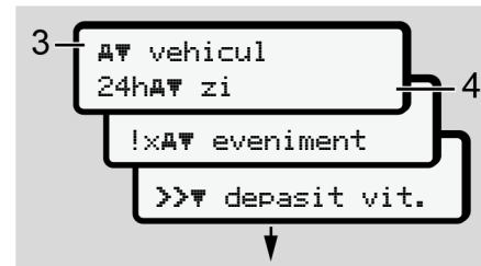
Fig. 78: Selectarea unei funcții de meniu
