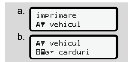
Fig. 92: Secvență de meniu Imprimare - Informații cartele tahografice
