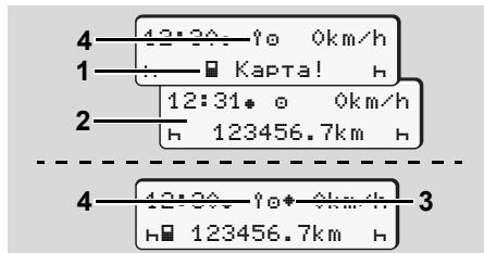
Указания после включения/выключения зажигания
