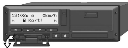
Fig. 9: Klap afdækningen ned
